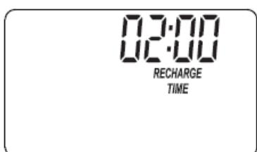
к экрану времени начала регенерации *RECHARGE TIME*, на экране должно мигать значение 02:00 (ночью) как подразумеваемое значение часа.
