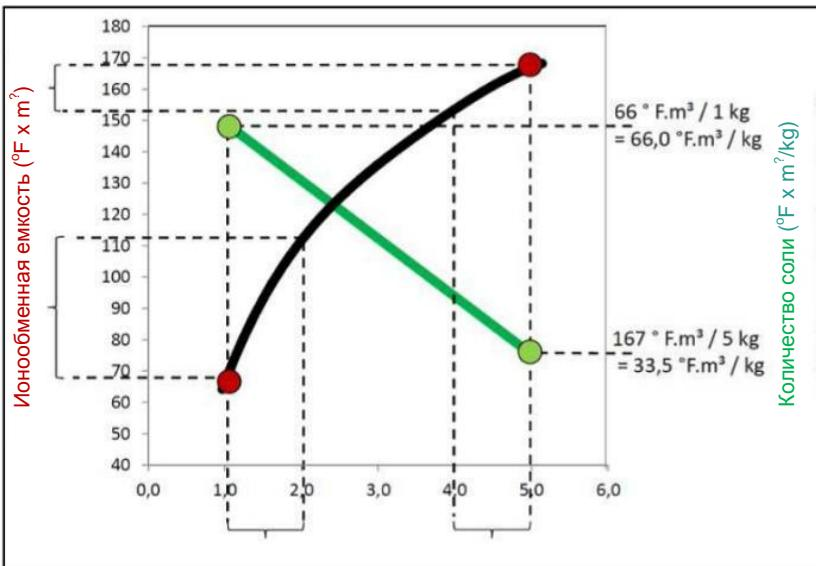
На имеющемся рядом графике показана зависимость между ионообменной ёмкостью сольного отложения, зависящей от количества соли, использованного в процессе регенерации, и производительностью соли в определённых областях восстановления ёмкости. Устройство выбирает периодичность регенерации на основе данных из графика, и стремится при этом минимизировать расход соли при регенерации солевого отложения.
